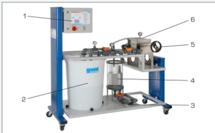
1 coffret de commande avec les éléments de commande, 2 réservoir de la suspension, 3 orifice de sortie et trop-plein réservoir à filtrat, 4 réservoir du filtrat, 5 broche, 6 filtre-presse à cadres et à plateaux
