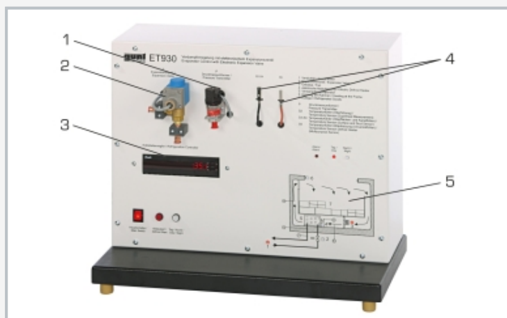
1 capteur de pression, 2 soupape de détente électronique, 3 affichage du régulateur de réfrigération, 4 capteur de température, 5 schéma du congélateur simulé
