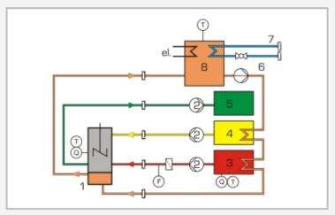
schéma de processus avec l'unité d'alimentation CE 310 1 réacteur à cuve agitée, 2 pompe péristaltique, 3 réservoir de réactif A, 4 réservoir de réactif B, 5 réservoir de produit, 6 pompe d'eau, 7 raccord d'eau, 8 réservoir d'eau; Q conductivité, F débit, T température
