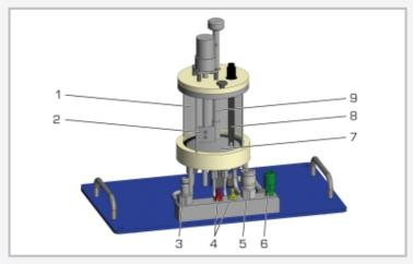
1 réacteur à cuve agitée, 2 mobile d'agitation, 3 alimentation d'eau, 4 alimentation des réactifs A/B, 5 évacuation d'eau, 6 évacuation de produit, 7 fond compartimenté comme échangeur de chaleur, 8 capteur de conductivité et de température (à partir de CE 310), 9 trop-plein modulable en hauteur
