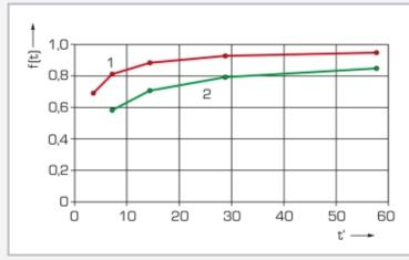
Conversions pour différentes temps de séjour (dans le réacteur) et températures. 1 température élevée, 2 température basse; f(t) conversion, t' temps de séjour (dans le réacteur)
