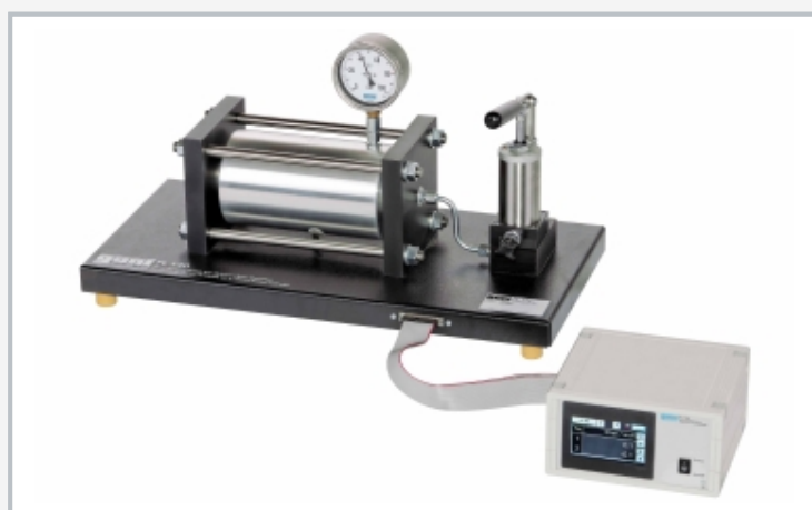
Ejemplo de aplicación: FL 152 en combinación con FL 140 (análisis de tensiones en un recipiente de pared gruesa)
