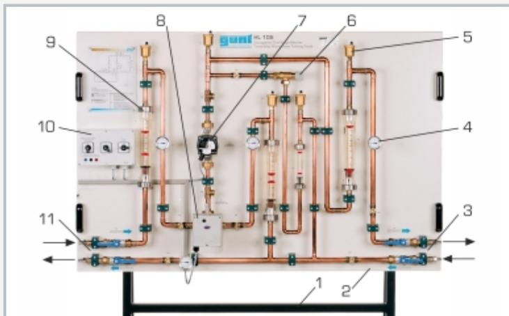
1 bâti, 2 panneau, 3 alimentation eau de chauffage, 4 thermomètre bimétallique, 5 purge d'air, 6 soupape de trop-plein pression différentielle, 7 pompe, 8 vanne à trois voies avec moteur de positionnement, 9 rotamètre, 10 coffret de commande pour commande de vanne, 11 raccords d'eau de chaudière
