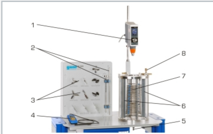
1 Rührwerk mit Drehzahl- und Drehmomentanzeige, 2 Turbinenrührer und Gewindewelle für Rührorgane, 3 Rührorgane, 4 Leitfähigkeitsmessgerät, 5 Ablauf, 6 Stromstörer, 7 Rohrschlange, 8 Absperrventil für Rohrschlange
