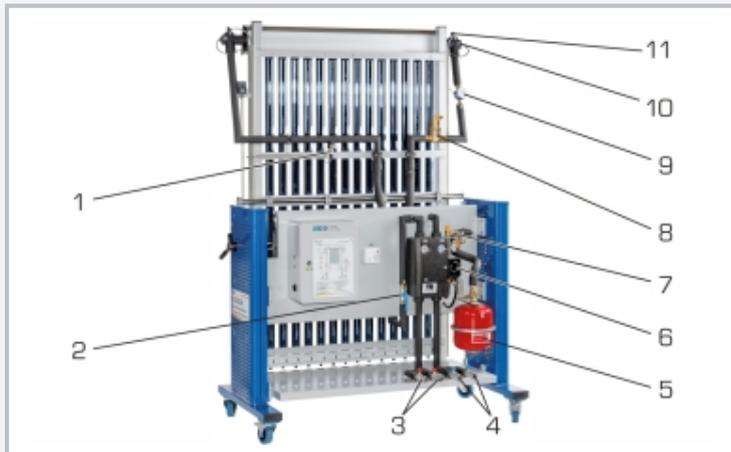
1 sensor de presión, 2 válvula de cierre, 3 conexiones para agua caliente, 4 conexiones para el agua fría, 5 vaso de expansión de membrana, 6 bomba de circulación, 7 válvula de sobrepresión, 8 separador de burbujas, 9 sensor de caudal, 10 sensor de temperatura, 10 válvulas de desaireación
