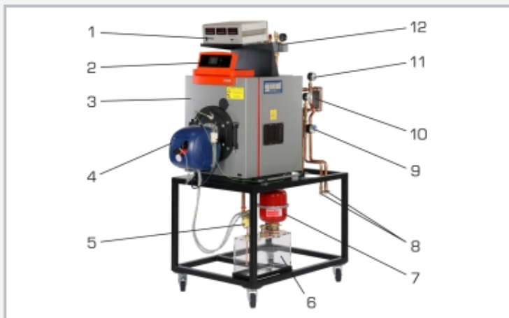
1 Messverstärker mit Digitalanzeigen, 2 Regeleinheit Kessel, 3 Heizkessel mit Sichtfenster, 4 Thermoelement, 5 Zweistrang-Ölfilter, 6 Ölbehälter, 7 Ausdehnungsgefäß, 8 Kaltwasseranschluss, 9 Wasserzähler, 10 Wärmeübertrager, 11 Thermometer, 12 Sicherheitsgruppe
