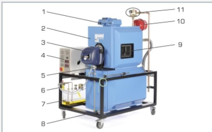
1 régulateur de chauffage, 2 chaudière de chauffage, 3 brûleur à fioul HL 352.01 (non compris dans la liste de livraison), 4 armoire de commande avec affichages numériques et champ de commande, 5 pression de gaz du manomètre, 6 filtre à fioul à deux branches, 7 réservoir de fioul avec robinetteries, 8 raccord de gaz, 9 fenêtre sur la chaudière de chauffage, 10 réservoir de dilatation 11 groupe de sécurité pour chaudières
