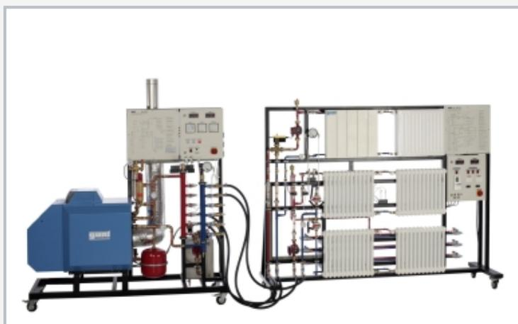
Installation de chauffage complète se composant de HL 353 et HL 353.02 Distribution thermique et régulation dans les systèmes de chauffage
