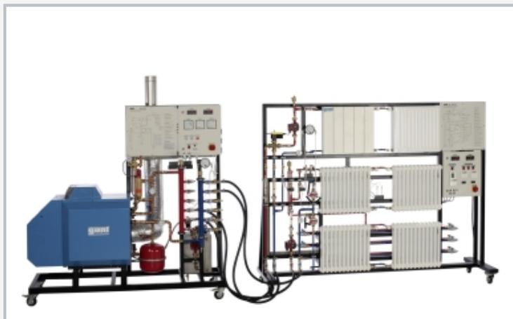
Vollständige Heizungsanlage bestehend aus HL 353 und HL 353.02 Wärmeverteilung und Regelung in Heizungssystemen
