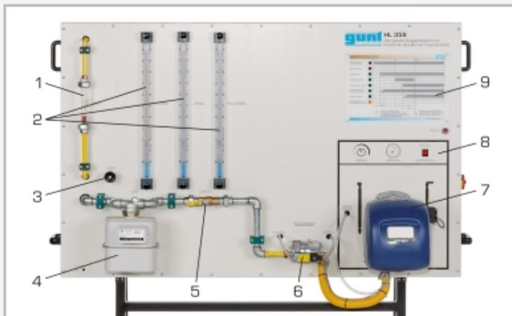
1 débitmètre, 2 manomètre, 3 soupape pour la quantité de gaz, 4 compteur à gaz, 5 robinet à tournant sphérique, 6 bloc compact, 7 brûleur, 8 éléments de commande de chauffage, 9 séquence de commande de brûleur
