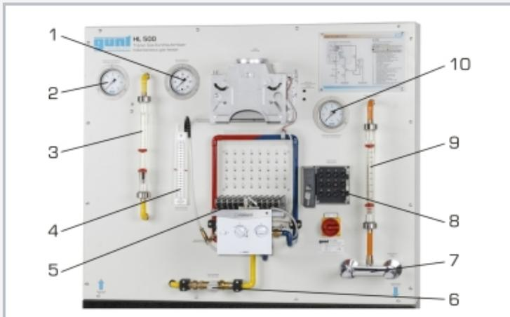
1 Gasdruck, 2 Wasserdruck Zulauf, 3 Schwabekörper-Durchflussmesser für Gas, 4 U-Rohr-Manometer für Differenzdruckmessung, 5 Gas-Durchlauferhitzer, 6 Hauptventil Gas, 7 Mischbatterie, 8 Taster zur Fehlersimulation, 9 Schwabekörper-Durchflussmesser für Wasser, 10 Wasserdruck Austritt
