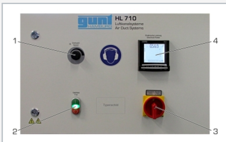
1 Einstellung Gebläsedrehzahl, 2 Schalter Gebläse, 3 Hauptschalter, 4 Leistungsmesser
