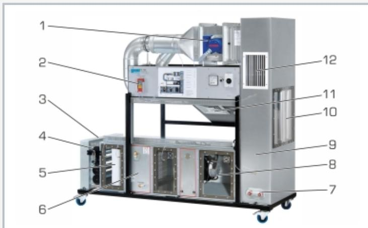
1 clapet coupe-feu, 2 appareil de mesure portable pour la pression, 3 grille de protection contre les intempéries, 4 persienne, 5 filtre, 6 échangeur de chaleur, 7 couvercle de révision, 8 ventilateur avec moteur d'entraînement, 9 conduit d'air, 10 silencieux à coulisse, 11 bouche de ventilation du plafond, 12 bouche de ventilation murale
