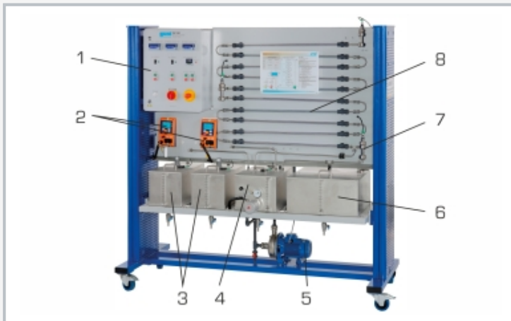
1 Schaltschrank, 2 Eduktumpen mit Volumenstrommessung, 3 Eduktbehälter, 4 Warmwasserbehälter, 5 Pumpe, 6 Produktbehälter, 7 Messung von Temperatur und elektrischer Leitfähigkeit, 8 Strömungsrohrreaktor mit 10 Abschnitten
