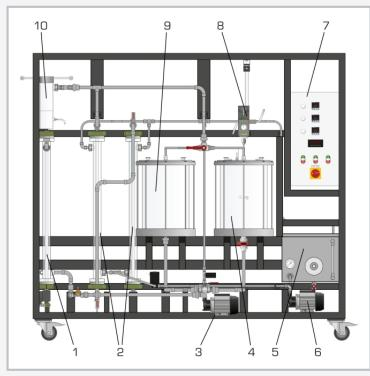
1 cambiador de calor para enfriar, 2 cambiador de calor para calentar, 3 bomba para la solución, 4 depósito de agitación para preparar la solución saturada, 5 depósito con dispositivo de calefacción regulado, 6 bomba del circuito de calefacción, 7 armario de distribución, 8 agitador, 9 depósito para la solución insuficientemente saturada, 10 célula de cristalización
