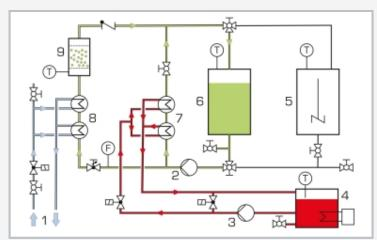
1 agua refrigerante externa, 2 bomba para la solución, 3 bomba del circuito de calefacción, 4 depósito con dispositivo de calefacción regulado, 5 depósito de agitación para preparar la solución saturada, 6 depósito para la solución insuficientemente saturada, 7 cambiador de calor para calentar, 8 cambiador de calor para enfriar, 9 célula de cristalización; T temperatura, F caudal
