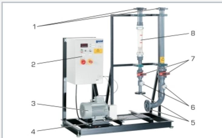
1 raccords à brides pour la liaison de HL 962 avec HL 962.30, 2 coffret de commande avec éléments d'affichage et de commande, 3 moteur électrique, 4 plaque de montage pour pompe d'essai, 5 raccords à brides pour pompe d'essai, 6 manomètre, 7 soupape, 8 débitmètre
