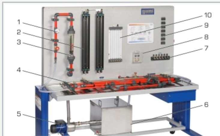
1 thermomètre, 2 manomètre à double tubes, 3 rotamètre, 4 différentes sections de tuyau, 5 pompe, 6 réservoir de stockage, 7 capteur de pression, 8 capteur de pression différentielle, 9 affichages numériques de la pression, 10 manomètre à 6 tubes
