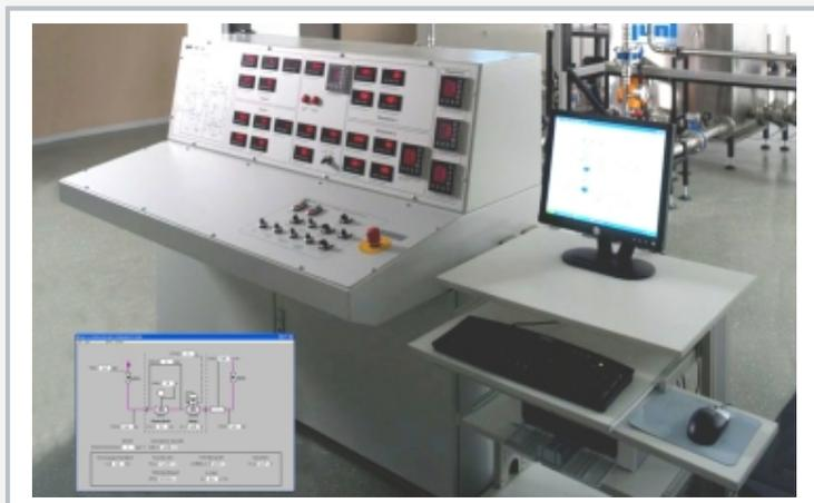
Poste de commande composé d'un pupitre de commande et d'une unité d'acquisition de données pour l'enregistrement et l'évaluation confortables des essais
