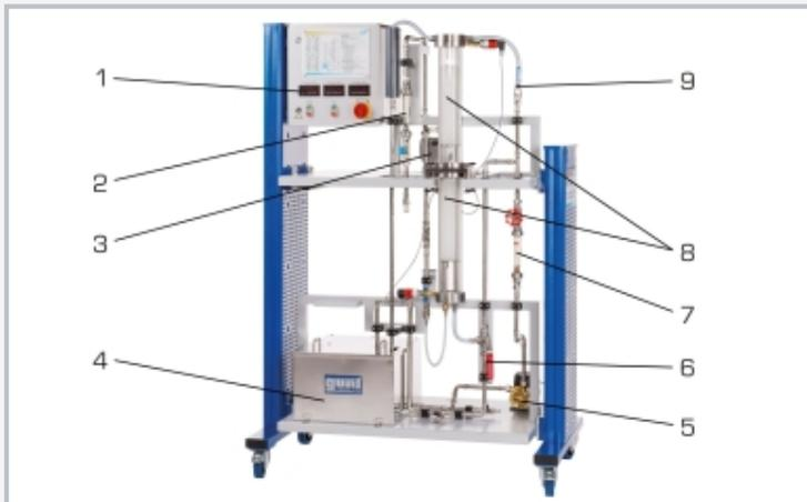
1 digitale Druckanzeigen, 2 Durchflussmesser Luft, 3 Verdichter für Luft, 4 Vorratsbehälter, 5 Pumpe für Wasser, 6 unterer Umschalhahn steigend-fallend, 7 Durchflussmesser Wasser, 8 zweiteilige Füllkörperkolonne, 9 oberer Umschalhahn steigend-fallend
