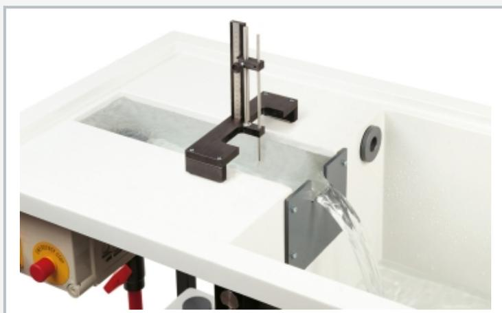
Module de base pour les essais réalisés en mécanique des fluides avec déversoir à paroi mince HM 150.03
