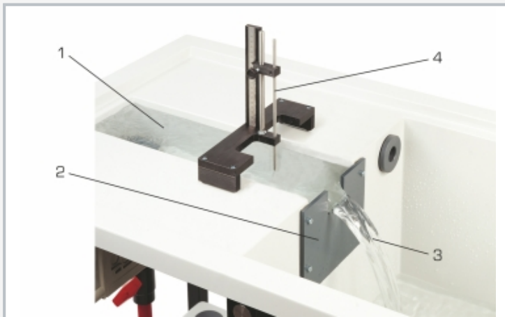
1 Versuchsrinne von HM 150, 2 Rehbockwehr, 3 Überfallstrahl, 4 Wasserstandstaster
