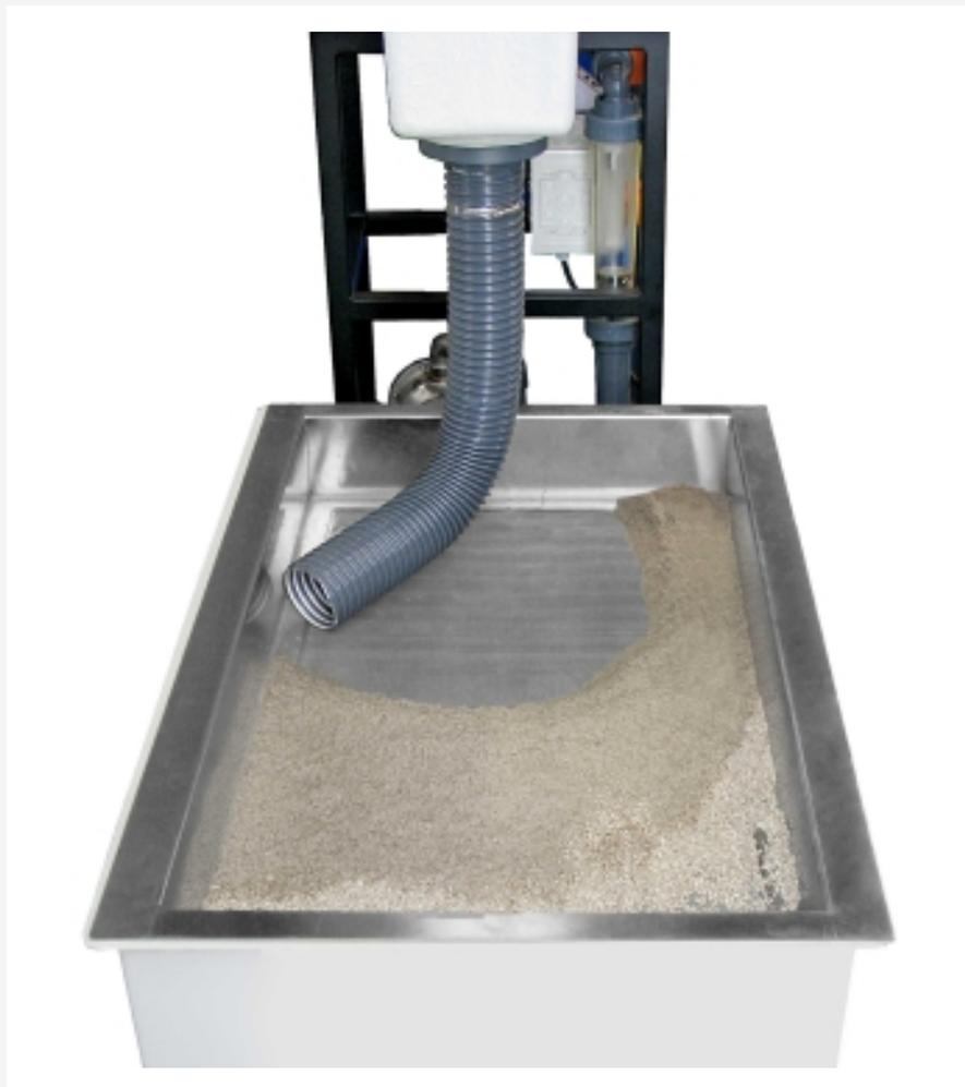
Piège à sédiments dans le réservoir en dessous de l'élément de sortie du HM 160.
