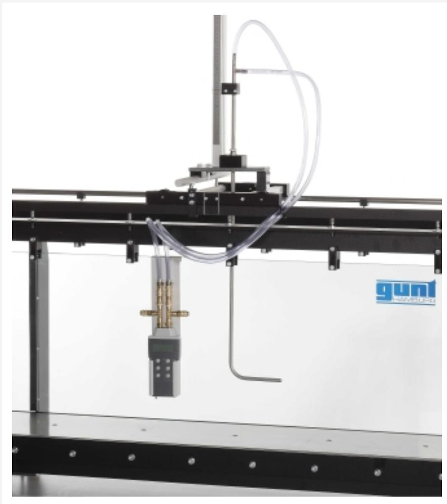
L'illustration montre un tube de Prandtl similaire sur un support pour instruments
