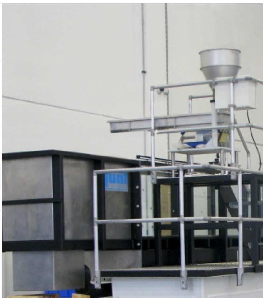
Die Abbildung zeigt den Sedimentfeeder auf einer Bühne.
