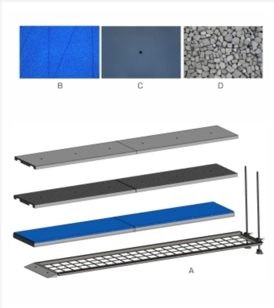
A Rahmen mit Neigungsverstellung, Detailabbildung Strandoberflächen: B durchlässige Oberfläche, C undurchlässige glatte Oberfläche, D undurchlässige raue Oberfläche
