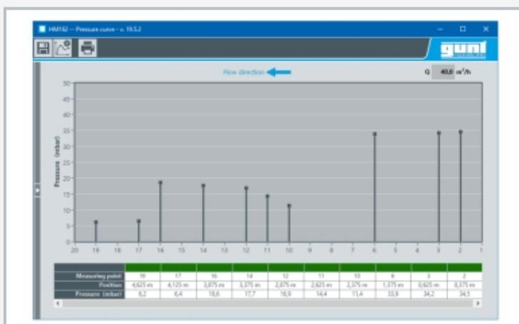
Screenshot der Software: Versuchsaufbau mit zwei Kontrollbauwerken (Schütz bei Messpunkt 17, Wehr bei Messpunkten 2, 3 und 6)
