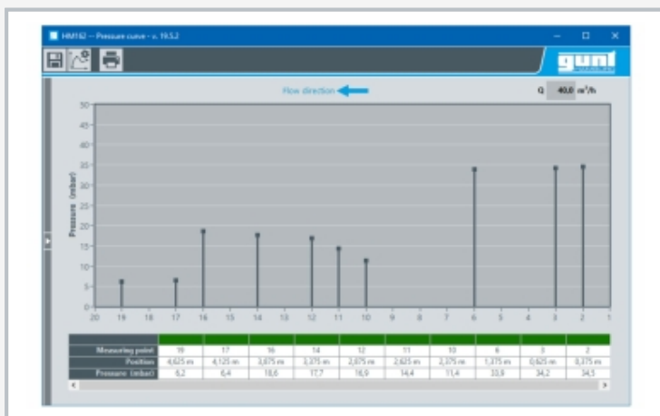
Capture d'écran du logiciel: le montage expérimental avec deux ouvrages de contrôle (contacteur au point de mesure 17, déversoir au points de mesure 10, 6 et 3)
