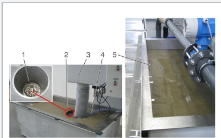
1 Siebkorb (Pumpe nicht dargestellt), 2 Sediment, 3 Ablaufelement von HM 162, 4 Leitungssystem zur Förderung des Wasser-Sediment-Gemischs, 5 Sieb zur Sedimententnahme auf 2. Wasserbehälter
