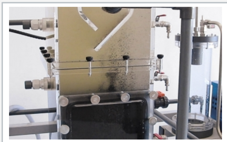
Réacteur UASB en mode essai
