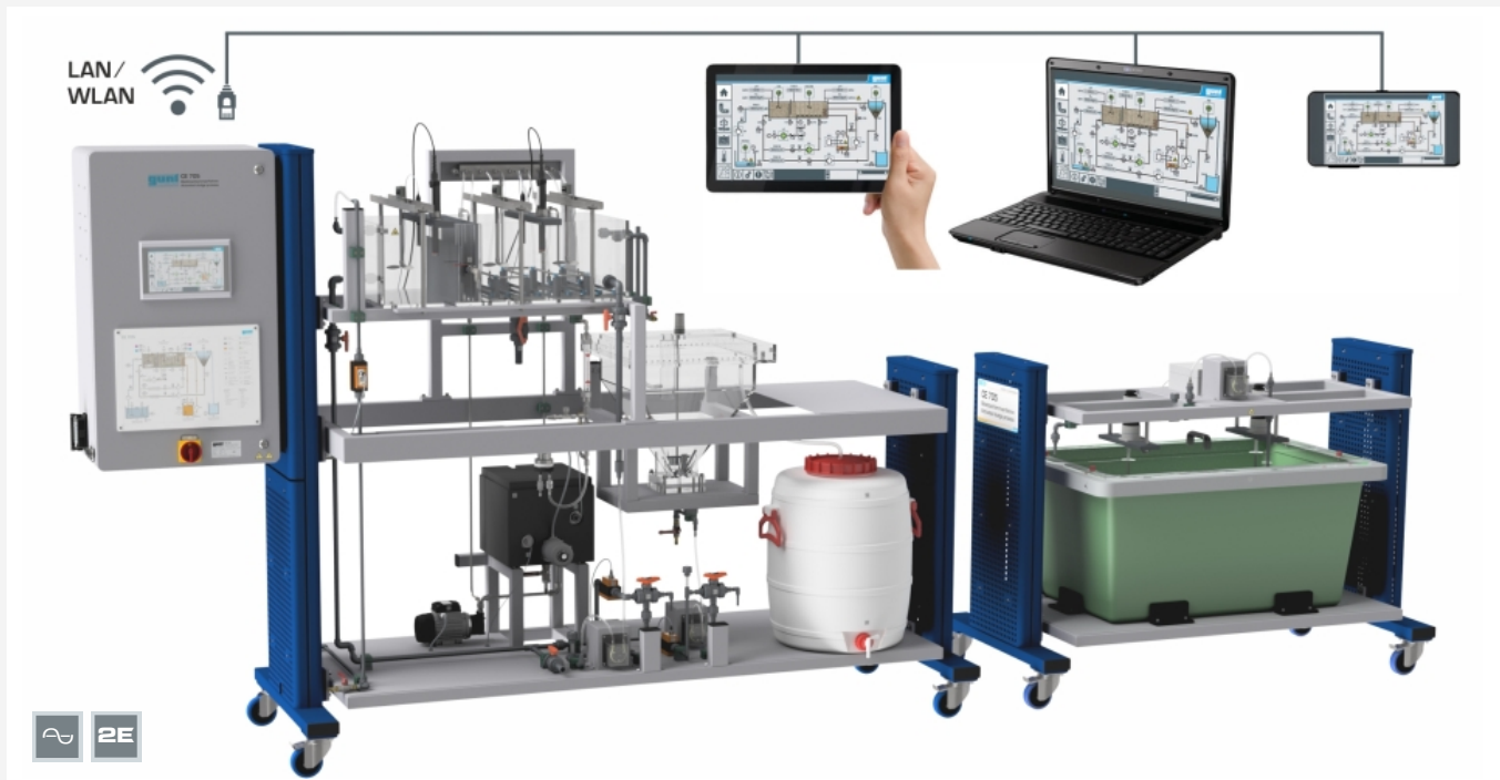
Die Abbildung zeigt: Versuchsstand (links) und Versorgungseinheit (rechts), Screen-Mirroring ist an verschiedenen Endgeräten möglich
