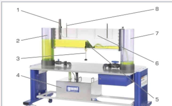
1 vanne plane, 2 alimentation en eau, 3 ajustage en hauteur du seuil, 4 réservoir de stockage, 5 déversoir à crête arrondie positionné dans le canal d'essai, 6 limite supérieure, 7 évacuation d'eau avec déversoir à paroi mince au niveau de la sortie d'eau, 8 tube de mesure
