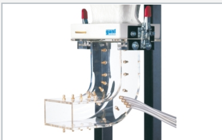
Untersuchung der Strömung in einem Rohrkrümmer mit dem Zubehör HM 225.05
