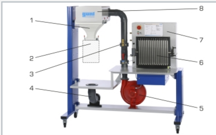
1 Düse, 2 Einbau Messstrecke, 3 Thermometer, 4 Abluftrohr, 5 Radialgebläse, 6 Rohrmanometer, 7 Schaltkasten mit Drehzahleinstellung, 8 Beruhigungsbehälter mit Strömungsgleichrichter
