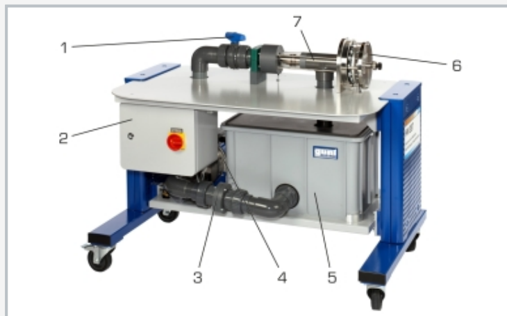
1 soupape pour l'ajustage du débit, 2 coffret de commande, 3 débitmètre avec orifice de mesure et capteur de pression différentielle, 4 pompe, 5 réservoir, 6 frein à courants de Foucault, 7 turbine axiale
