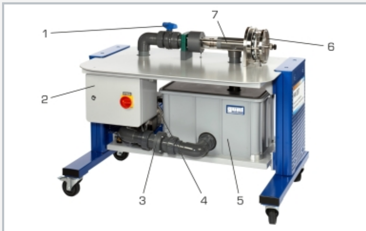
1 Ventil zur Einstellung des Durchflusses, 2 Schaltschrank, 3 Durchflussmessung mit Messblende und Differenzdruckaufnehmer, 4 Pumpe, 5 Behälter, 6 Wirbelstrombremse, 7 Axialturbin
