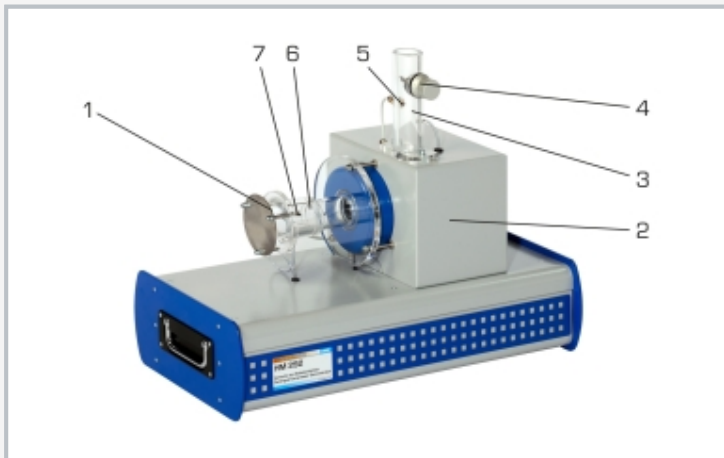
1 Lufteintritt mit Schutzplatte, 2 zweistufiger Radialverdichter mit Antriebsmotor, 3 Druckrohr, 4 Drosselklappe, 5 Temperaturaufnehmer, 6 Saugrohr, 7 Druckaufnehmer
