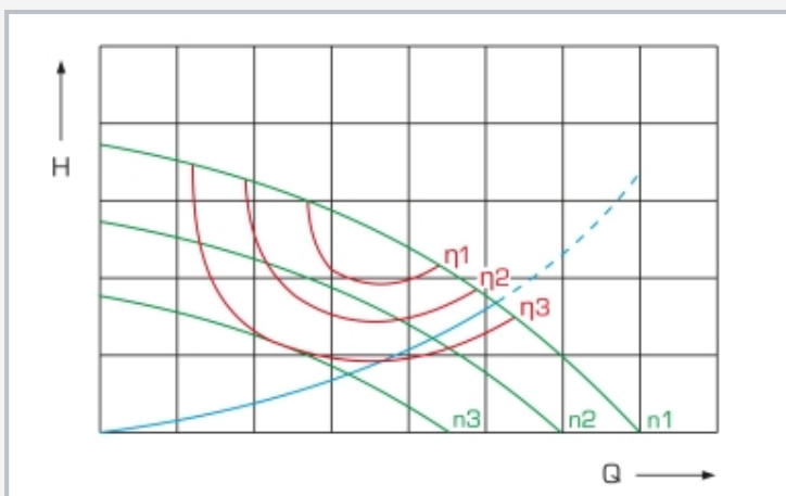
Kennfeld der Kreislumpumpe: grün Pumpenkennlinien bei unterschiedlichen Drehzahlen, blau Anlagenkennlinie, rot Kennlinie konstanter Wirkungsgrade; H Förderhöhe, Q Durchfluss, n Drehzahl
