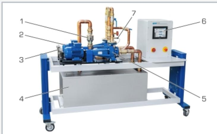
1 débitmètre électromagnétique, 2 moteur d'entraînement, 3 capteur de force, 4 réservoir de stockage, 5 pompe, 6 écran tactile, 7 capteur de pression
