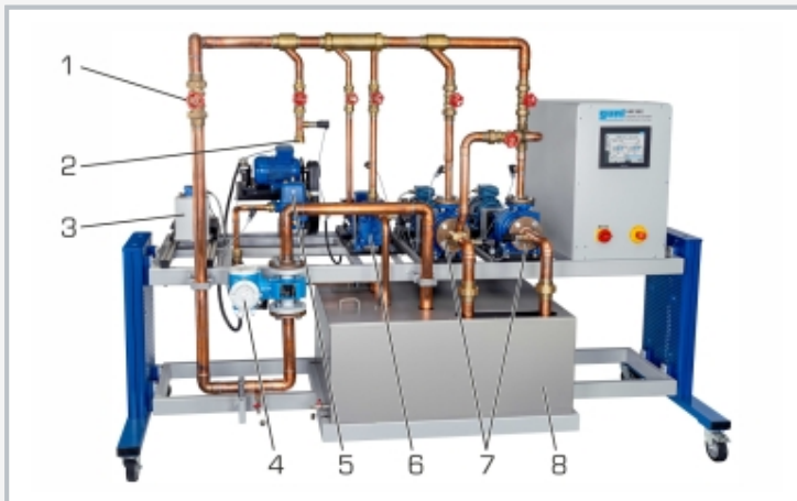
1 Drosselventil am Austritt, 2 Anschluss für zusätzliche Pumpe, 3 Motor für zusätzliche Pumpe, 4 Durchflussaufnehmer, 5 Kolbenpumpe, 6 Seitenkanalpumpe, 7 Kreiselpumpe, 8 Vorratsbehälter
