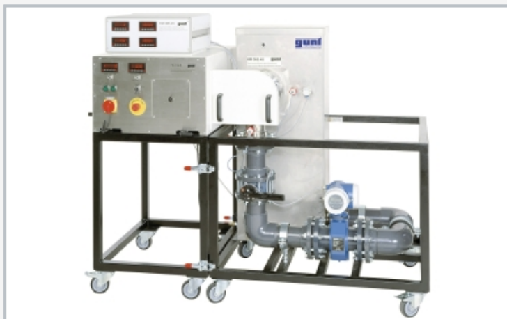
Beispiel für einen vollständigen Versuchsaufbau: Axialpumpe HM 365.45, angeschlossen an HM 365 Universale Brems- und Antriebseinheit
