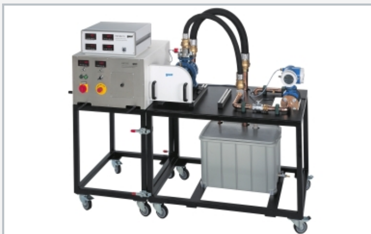
Funktionsfähiger Versuchsaufbau: Antriebseinheit HM 365 (links), HM 365.10 mit zu untersuchender Pumpe (rechts)
