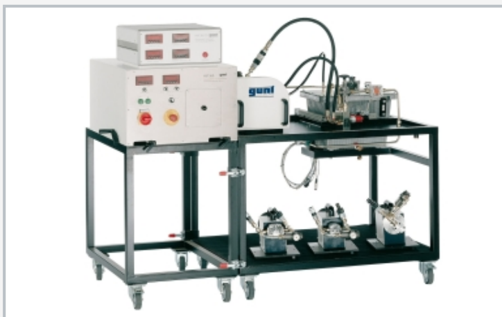
funktionsfähiger Versuchsaufbau: Antriebseinheit HM 365 (links), HM 365.20 mit zu untersuchender Pumpe (rechts)
