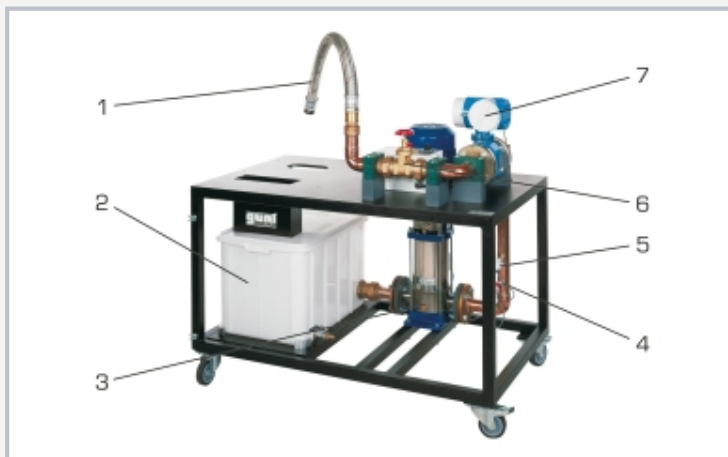
1 arrivée d'eau turbine, 2 réservoirs, 3 pompe centrifuge, 4 point de mesure de la pression, 5 point de mesure de la température, 6 soupape d'étranglement, 7 débitmètre
