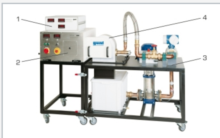
1 amplificateur de mesure avec affichage numérique des valeurs de mesure, 2 unité de freinage et d'entraînement universelle HM 365, 3 HM 365.32, 4 turbines Pelton et Francis HM 365.31
