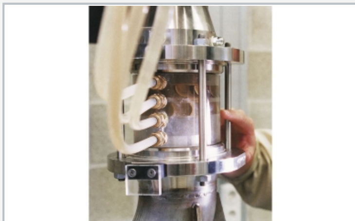
L'illustration montre les phénomènes de cavitation dans la zone de travail de la turbomachine axiale
