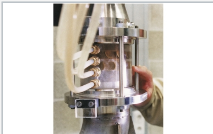
Die Abbildung zeigt Kavitationserscheinungen im Arbeitsbereich der axialen Strömungsmaschine
