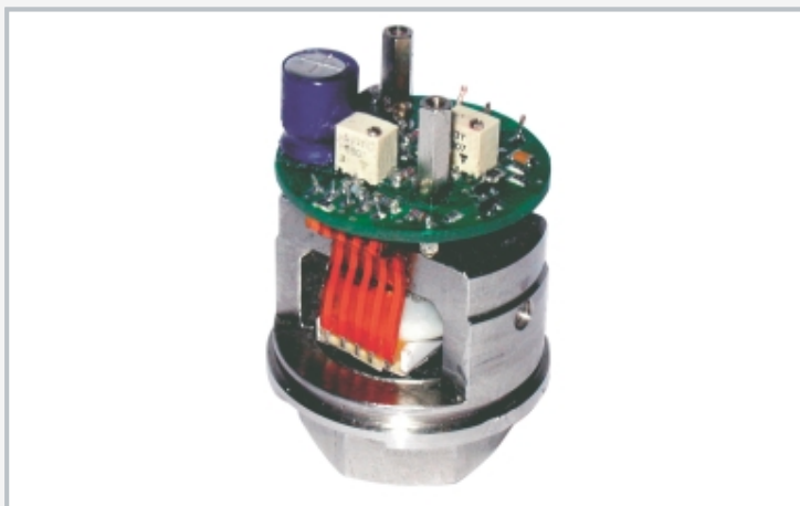
Innerer Aufbau eines elektronischen Druckaufnehmers
