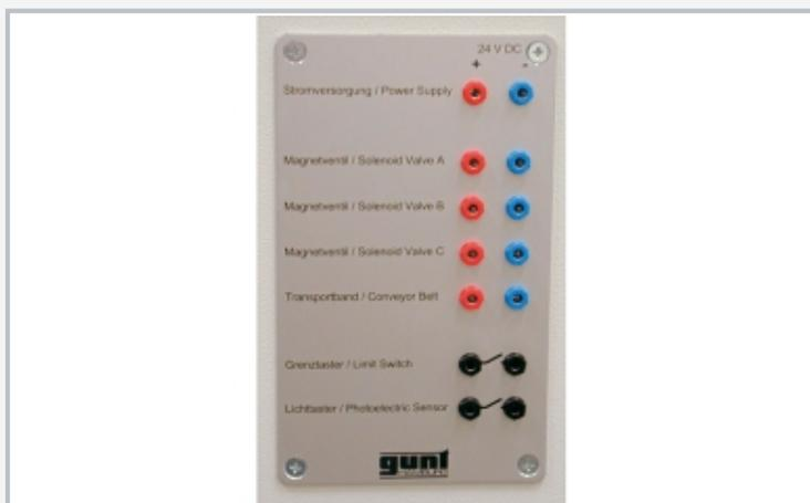
Connexions électriques des électrovannes et des capteurs
