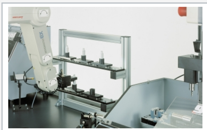
Die Abbildung zeigt den Roboter bei der Ablage eines bearbeiteten Werkstücks in eine Palette des Fertigteilmagazins
