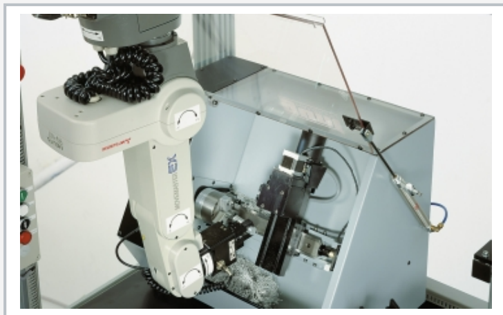
L'illustration montre le robot prélevant une pièce du tour
